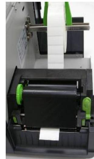
Ruotare la rotella sul riavvolgitore nastro per mettere in tensione il nastro, rimuovere eventuali grinze dal nastro e per allineare il nastro sui mandrini.
