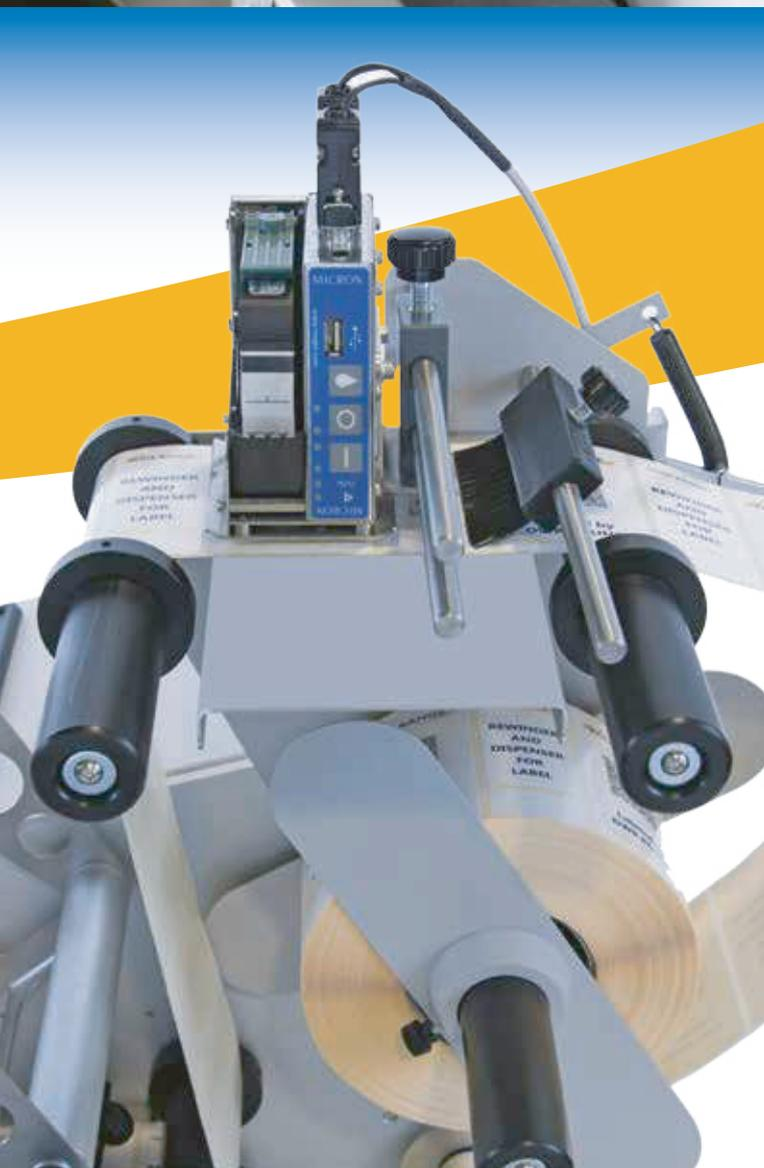
DWR ROUND può essere dotata di un marcatore a getto d'inchiostro con tecnologia HP per la scrittura di dati variabili quali data, ora, codici a barre, testi con altezza massima di 12,7 mm. risoluzione di 300 dpi e velocità sincronizzata a quella di avanzamento dell'etichetta.
