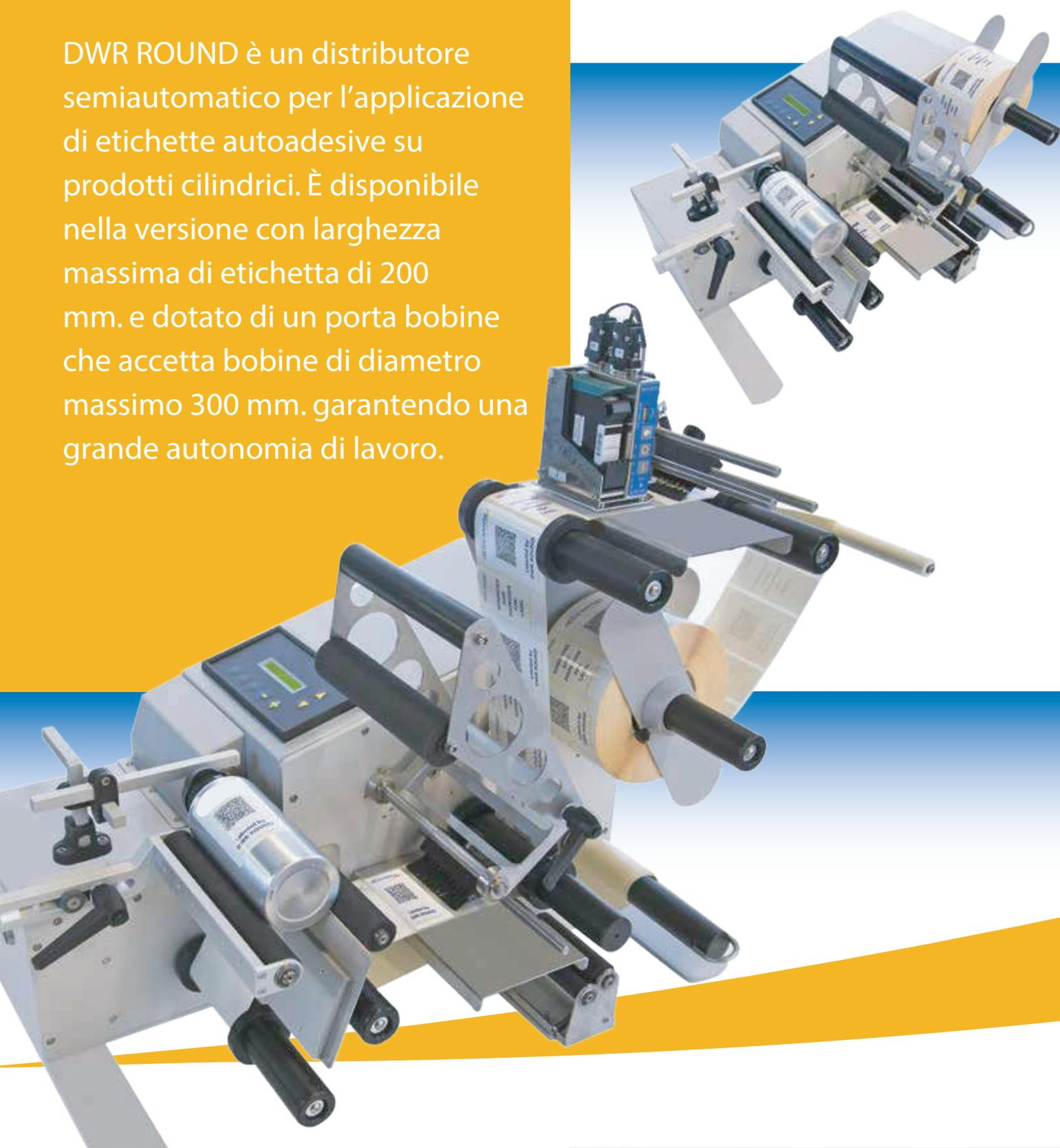
L'elettronica è sviluppata su una monoscheda realizzata con tecnologia SMD. Utilizza un microprocessore a 16/32 Bit. L'interfaccia utente avviene tramite display LCD a due linee di 40 caratteri e 7 tasti funzione. Il software permette di memorizzare sino a 40 differenti programmi di lavoro inserendo nel programma tutte le informazioni dell'etichetta e del tipo di applicazione rendendo il cambio formato estremamente rapido.
