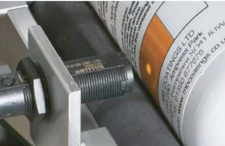
DWR ROUND può applicare una etichetta avvolgente o fronte e retro anche di dimensioni differenti posizionate sulla stessa bobina. DWR ROUND può anche applicare una etichetta a registro leggendo per esempio una tacca di colore sul prodotto o leggendo una etichetta precedentemente applicata.
